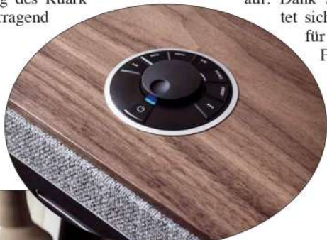
Fest verbaut auf der Oberseite sitzt das mit der Fernbedienung identische Bedienfeld
